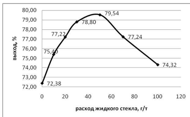
Рис. 14. Выход кварца в пенный продукт при флотации не обработанным амином при различных расходах жидкого стекла (рН = 9,5, С<sub>амин</sub> = 8,8 мг/л)
